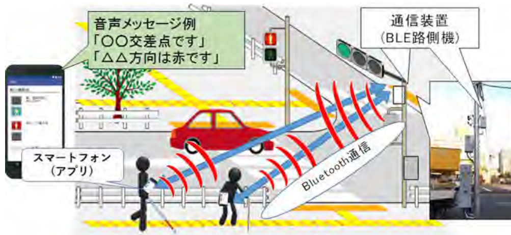
高度化 PICS 対応型信号機
